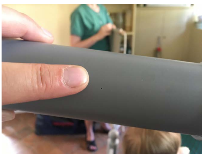
Découverte du rideau d'eau avec explication technique de Lucile. Visualisation collective des microperçages et des annotations d'usage.
